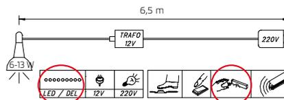
Diese Leuchte enthält eingebaute LED-Lampen der Energieklassen A++ - A\*. Die Lampen können in der Leuchte nicht ausgetauscht werden.
